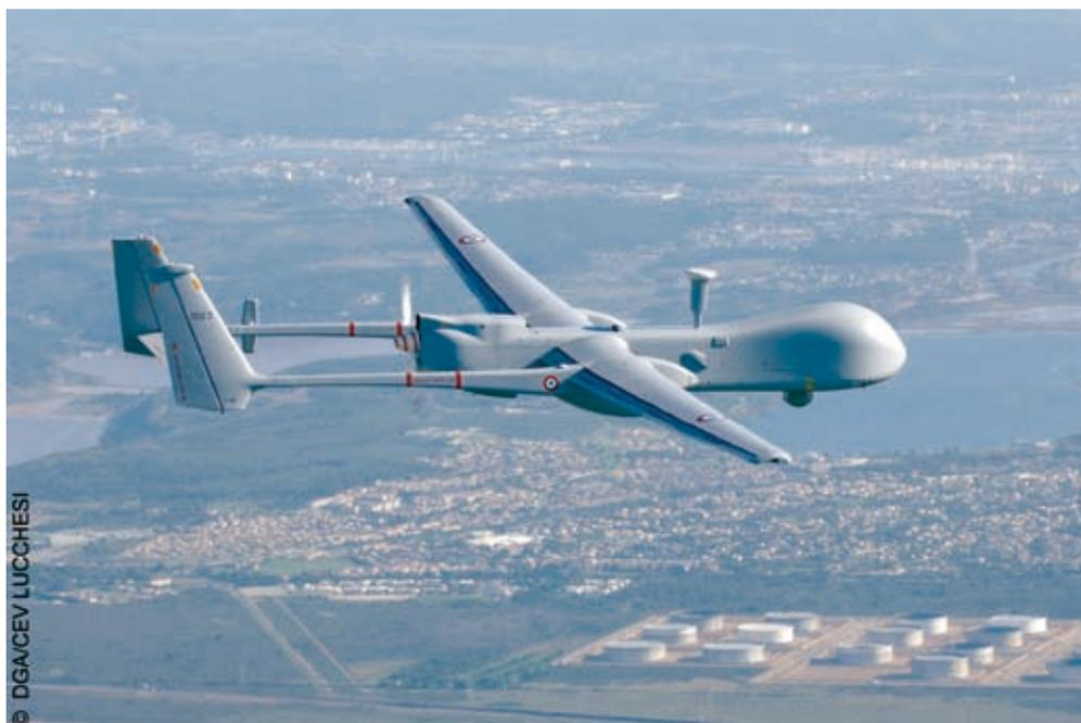
Le SIDM (Système intérimaire de drone Moyenne Altitude Longue Endurance) est un système de drone, d'architecture modulaire, capable d'assurer des missions de surveillance, de reconnaissance et des missions de désignation d'objectif.
