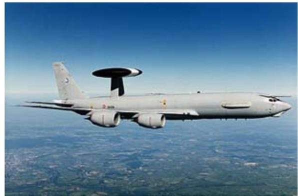
Le système de détection et de commandement aéroporté (SDCA) permet de combler les zones de détection aveugles des radars de surveillance traditionnels. C'est également un acteur majeur des opérations aériennes.
