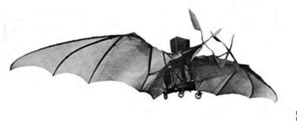
Dénommé *Éole*, cet engin, en forme de chauve-souris, permet en 1890 à Clément Ader, son inventeur, d'accomplir un bond de 50 mètres, à seulement quelques dizaines de centimètres de hauteur.
