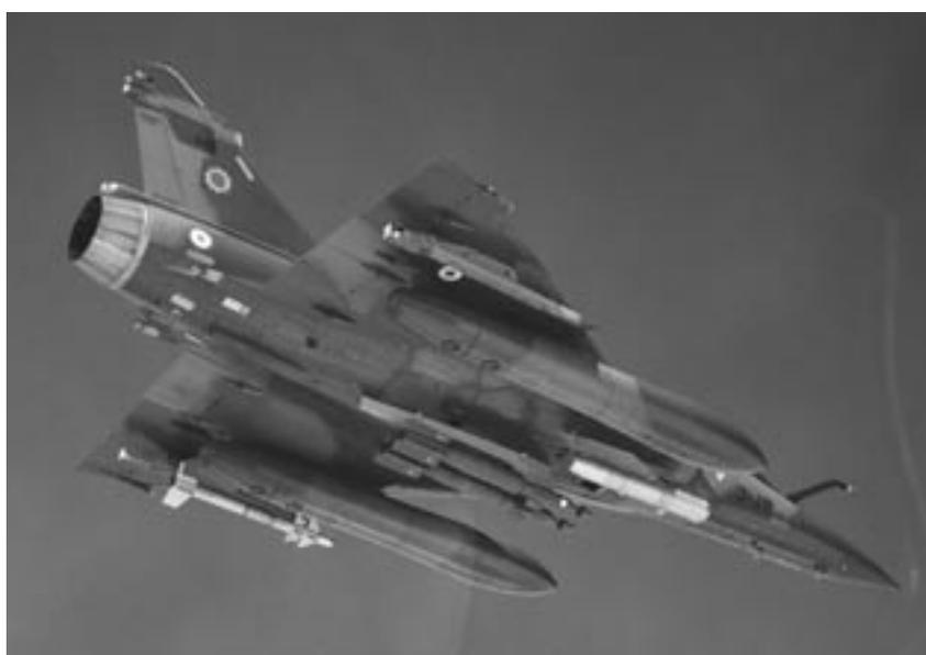
La configuration bi-GBU 12, visible sous ce *Mirage 2000D*, est celle utilisée en Afghanistan.
