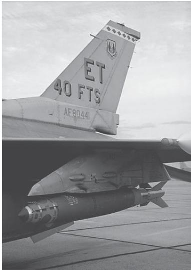
GBU-38 JDAM de 500 lbs avec une bombe MK-82 avec guidage GPS (précision de 3 à 7 m).
