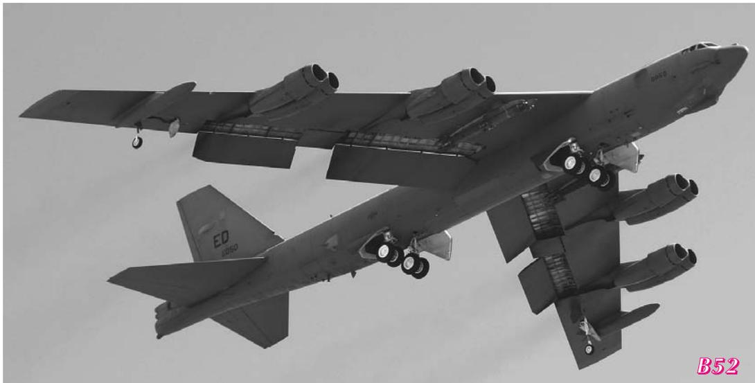
Conçu à partir de 1945, le B-52 se caractérisait par des ailes en flèches et huit turboréacteurs montés par paires dans des nacelles sous voilure. Ses deux dernières versions, armées de missiles de croisière, sont encore en service.
