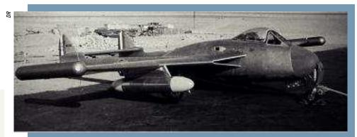
Mistral téléguidé: Une dizaine de Mistral téléguidés ont été utilisés afin de servir de cibles radioguidées pour la mise au point des missiles air-air. Les missiles tirés n'étaient pas tous à charge explosive et les avions étaient dotés de bidons-caméras spéciaux fixés sous les ailes. D'autres bidons, fixés en bouts d'ailes, étaient équipés de dispositifs proximétriques associés à un jeu de caméras. Ces Mistral ont été les derniers avions de ce type maintenus en état de vol.
