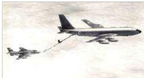
Au début de la mise en service des *Mirage IV*, compte tenu du faible nombre d'avions en ligne, les premiers équipages, pour se familiariser avec le ravitaillement en vol, effectuaient des ravitaillements fictifs *Vautour* sur *Vautour*, ou *Vautour* sur ravitailleur *C135F*. C'est dans ce cadre qu'a été prise la photo jointe du *Vautour 2A* n° 4 en simulacre de ravitaillement en vol sur un *C135F*. On ne connaît pas la date précise de la prise de vue, ni le nom de l'auteur de cette photo. ■
