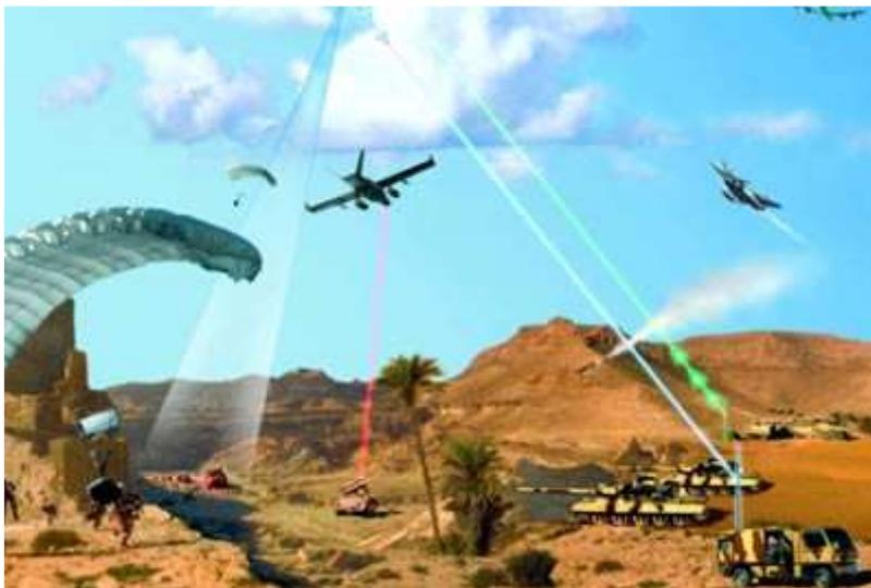
Exemples d'utilisation de drones militaires : largage de packs de survie (parachutés) à des commandos avancés, surveillance de mouvements ennemis sur route, désignation par laser d'un objectif au sol permettant le tir depuis un avion d'armes et relais de communications (entre une station au sol et un avion haute altitude).
