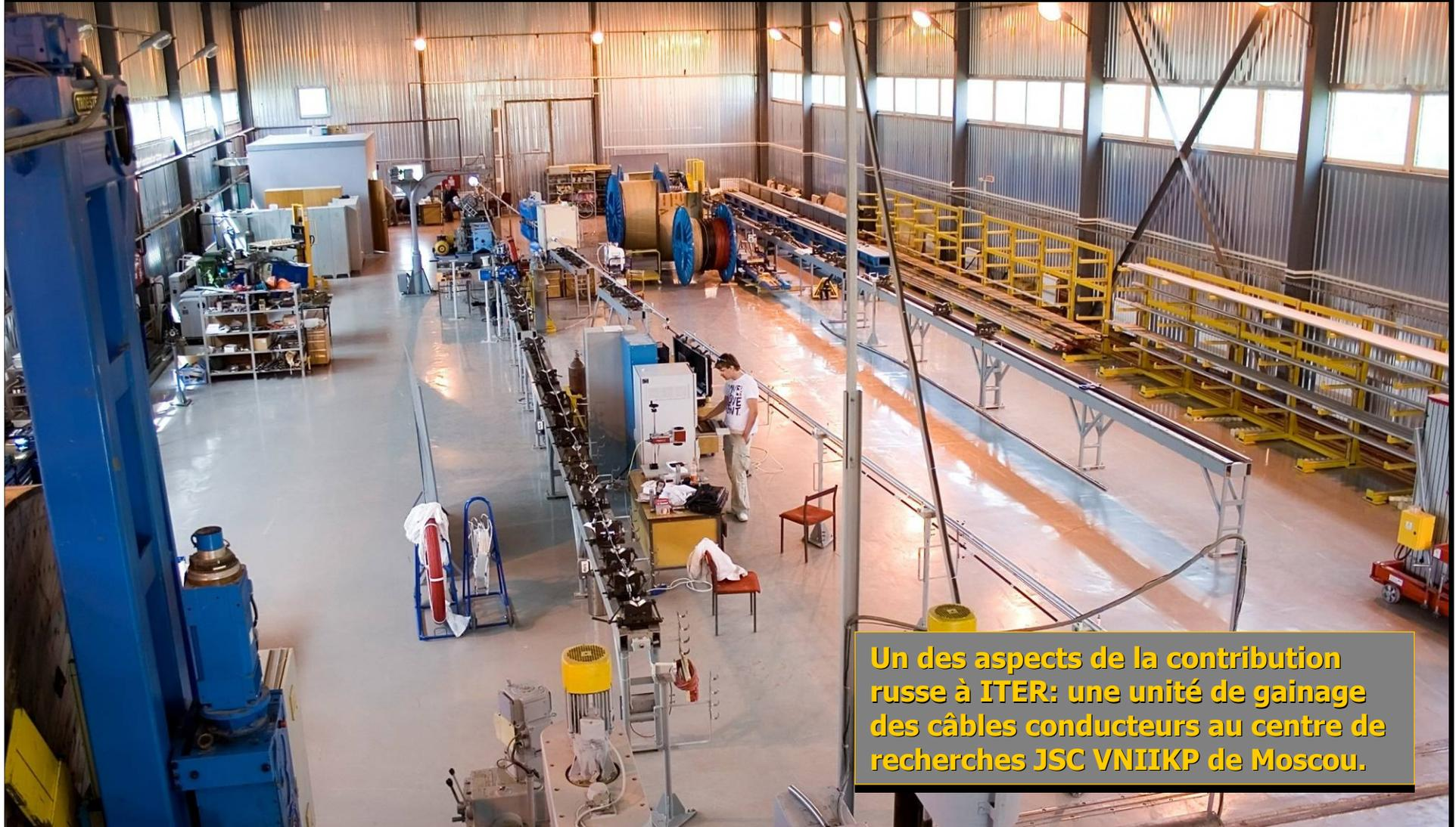
**Un des aspects de la contribution russe à ITER: une unité de gainage des câbles conducteurs au centre de recherches JSC VNIKP de Moscou.**
