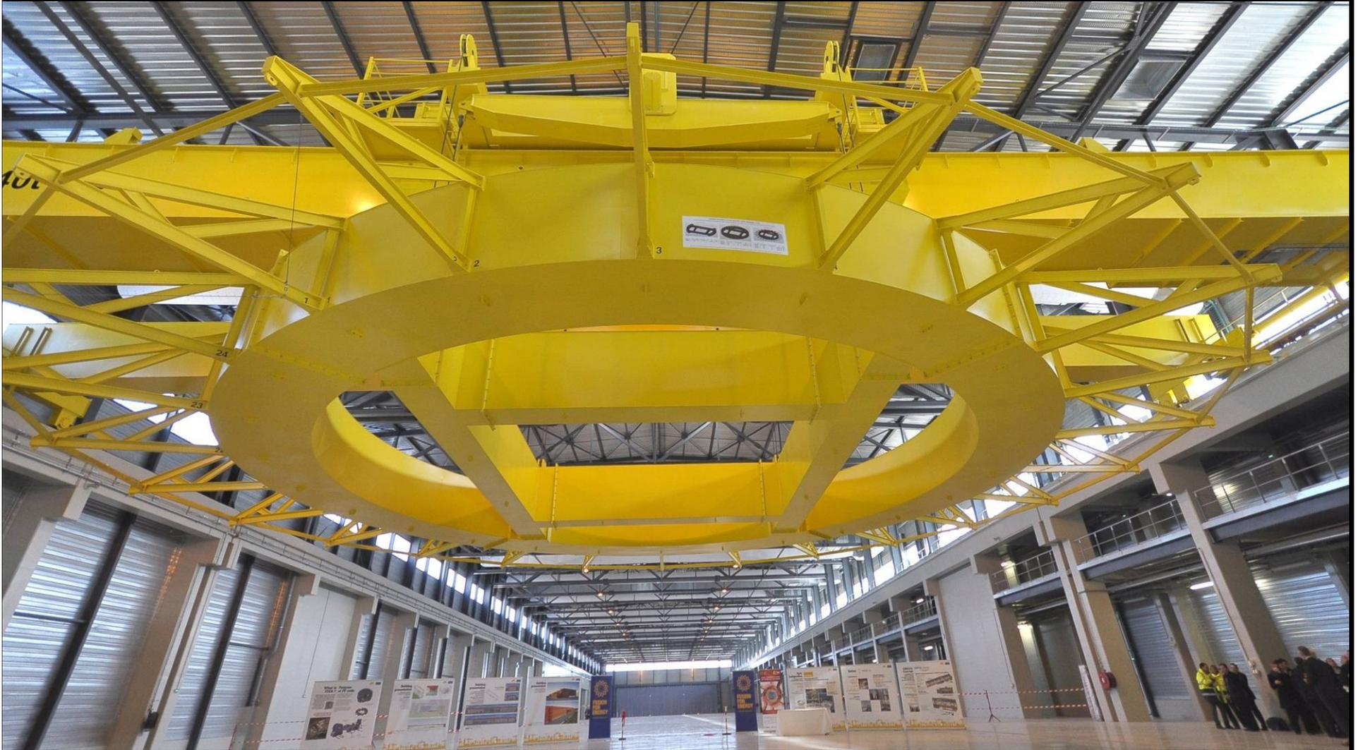
Palonnier et pont-roulant sont installés dans le bâtiment d'assemblage des bobines "PF".
