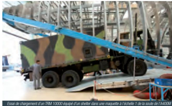
Essai de chargement d'un TRM 10000 équipé d'un shelter dans une maquette à l'échelle 1 de la soute de l'A400M
