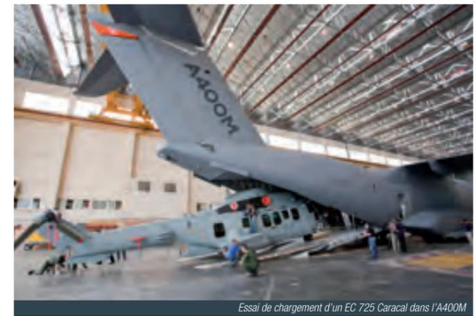
Essai de chargement d'un EC 725 Caracal dans l'A400M
