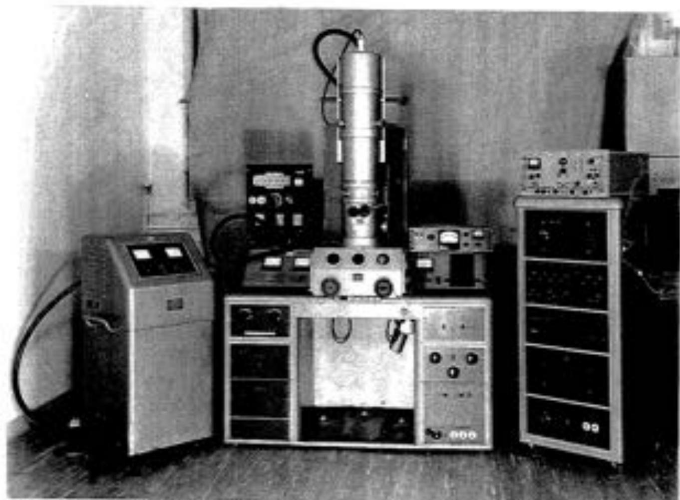
Machine à usiner par faisceau d'électrons
