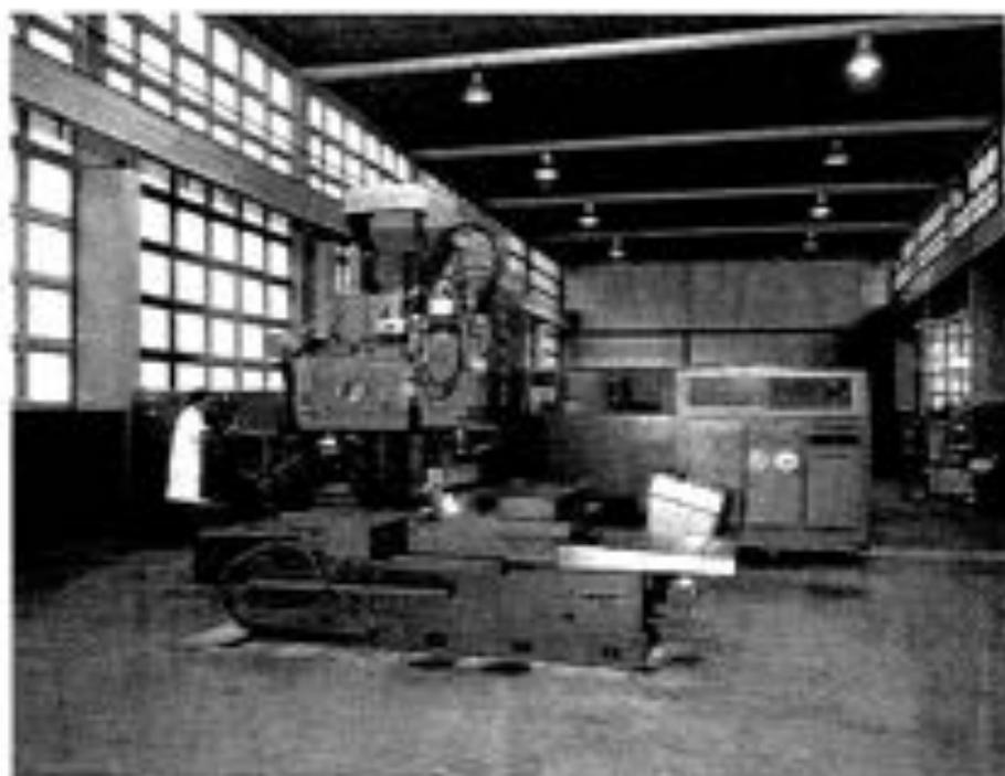
**Fraiseuse multiaxes à commande numérique, atelier pilote**
