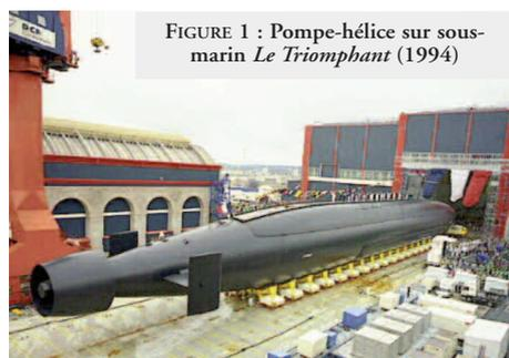
FIGURE 1 : Pompe-hélice sur sous-marin *Le Triomphant* (1994)
