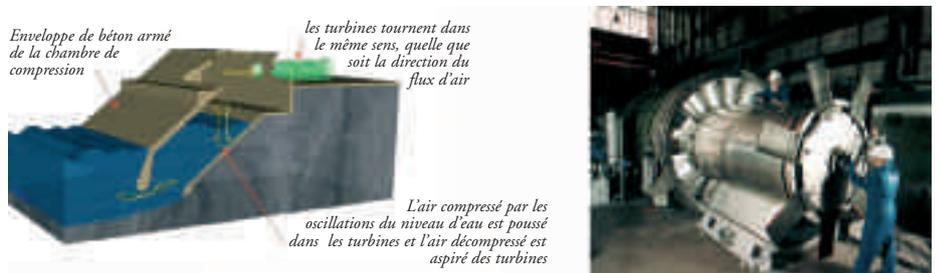
Figure 13.– Énergie de la houle, projet Limpet (UK), d'exploitation de l'énergie par colonne d'air oscillante.
