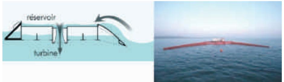
Figure 12.– Énergie de la houle, projet Wave Dragon (UK) d'exploitation de la houle par déversement.
