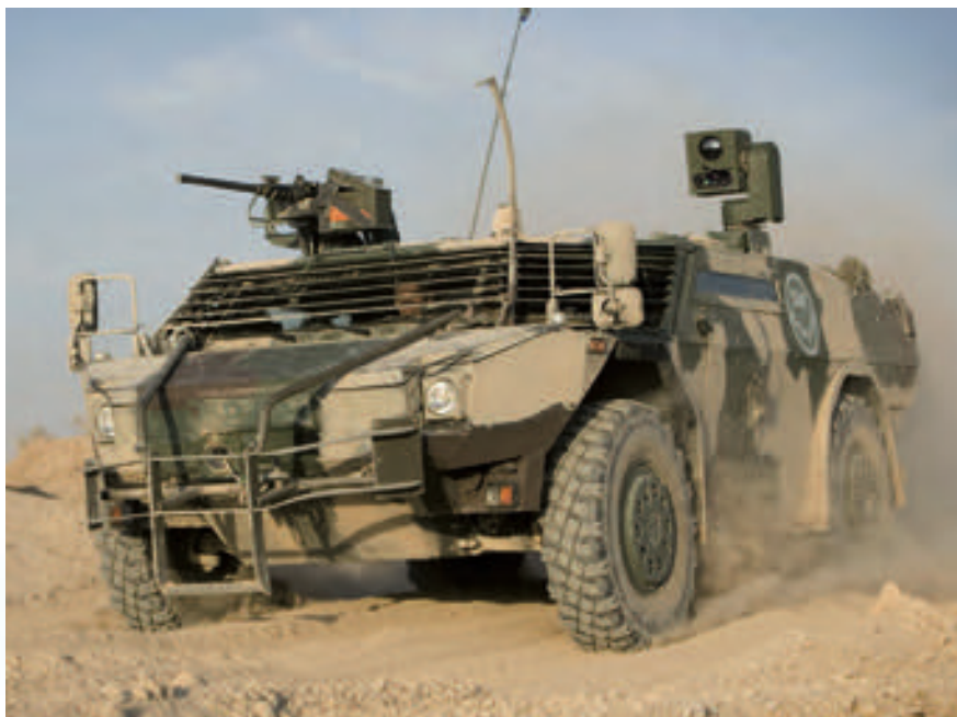
Fig. 4 : Le véhicule blindé FENNEK d'un JFST allemand. Le JFST consiste de deux FENNEK (une équipe sol-sol et une équipe sol-air)
