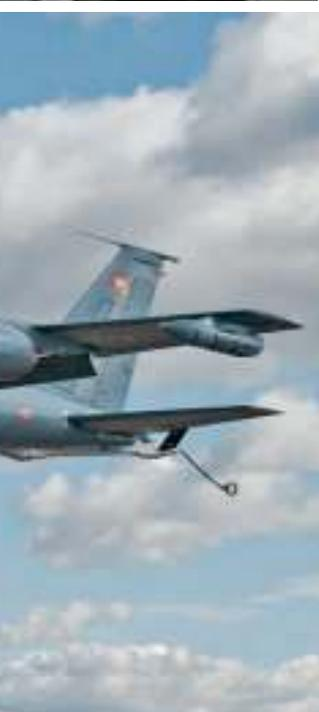
**C**inq mètres, quatre, trois, deux, un, contact! Ça coule!» annonce par radio l'opérateur de ravitaillement en vol (ORV) au pilote d'un Mirage 2000. En deux minutes, l'avion de chasse connecté à l'extrémité de l'aile droite du Boeing reçoit une tonne de kérosène. À gauche, relié au second panier de ravitaillement, un Rafale en a perçu le double.
