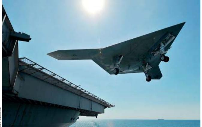
Un drone de combat furtif X-47B est catapulté du pont d'envol du porte-avions américain *USS George H.W. Bush.* Ce drone armé supersonique est complètement autonome dans sa navigation et sa décision de tir. Il peut être considéré comme le premier robot soldat.
