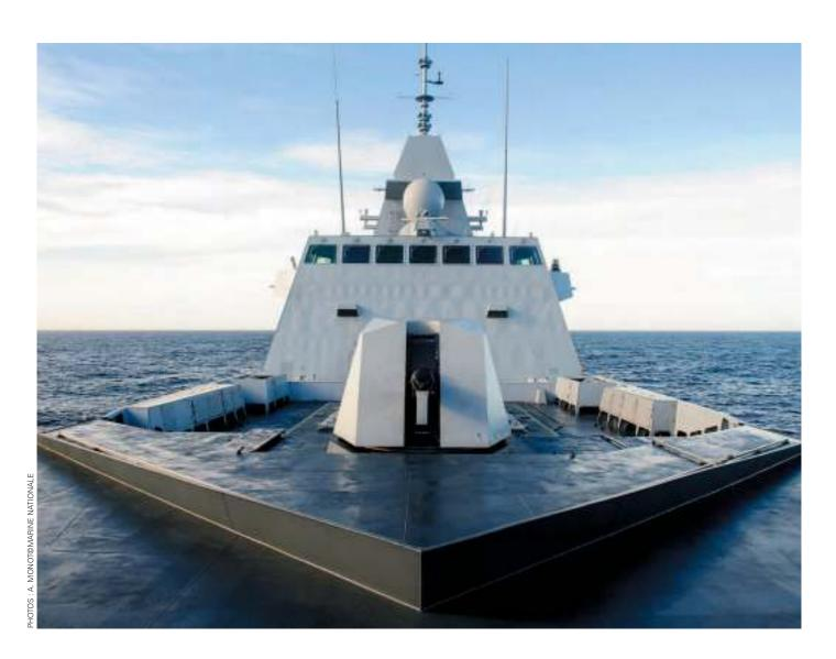
Ci-dessus : la silhouette profilée de l'Aquitaine permet de diminuer la signature radar du navire. À bord, l'ergonomie des installations, des outils de conduite jusqu'aux espaces de vie courante, est très novatrice.
