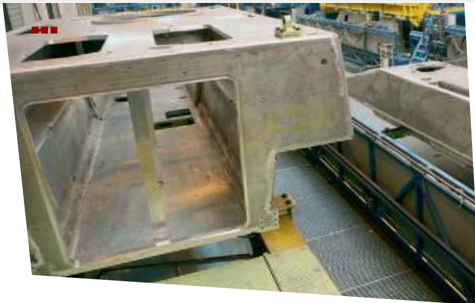
La caisse du VBCI, avec les découpes dans le glacis pour accueillir les trappes et la tourelle. Ci-dessous le 6-cylindres Diesel de 550 chevaux.
