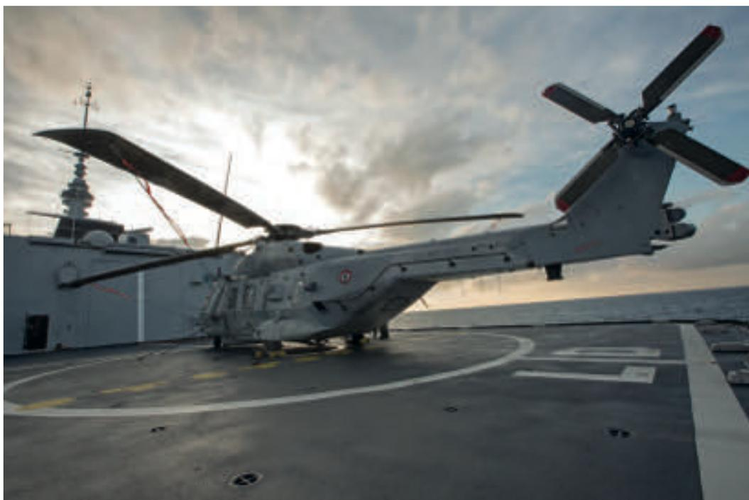
Hélicoptère embarqué, le NH90 Caïman Marine est équipé d'un sonar basse fréquence Flash pour la détection initiale. Il peut aussi larguer des bouées acoustiques et emporter deux torpilles MU90.
