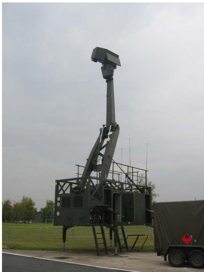
**FIG.3 - La surveillance et la détection : le radar GIRAFFE**
